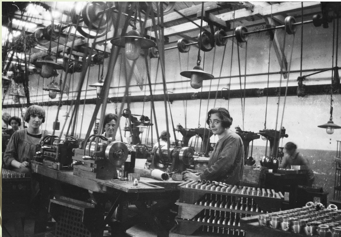
Kobiety polerują zapalniki czasowe szmergłem na szlifierkach stołowych
